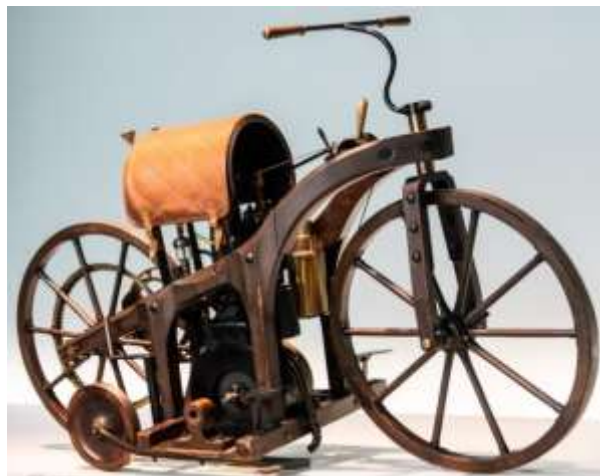
Rys. 13.1 Opracowany w roku 1885 przez Gottlieba Daimlera i Wilhelma Maybacha pierwszy motocykl z silnikiem spalinowym
