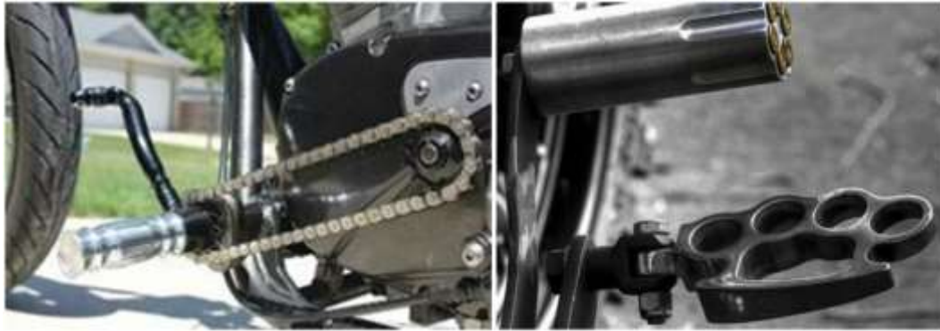
Rys. 13.13 Przykłady indywidualnego wykonania podnóżków i dźwigni nożnych w motocyklu Źródło: [8]
