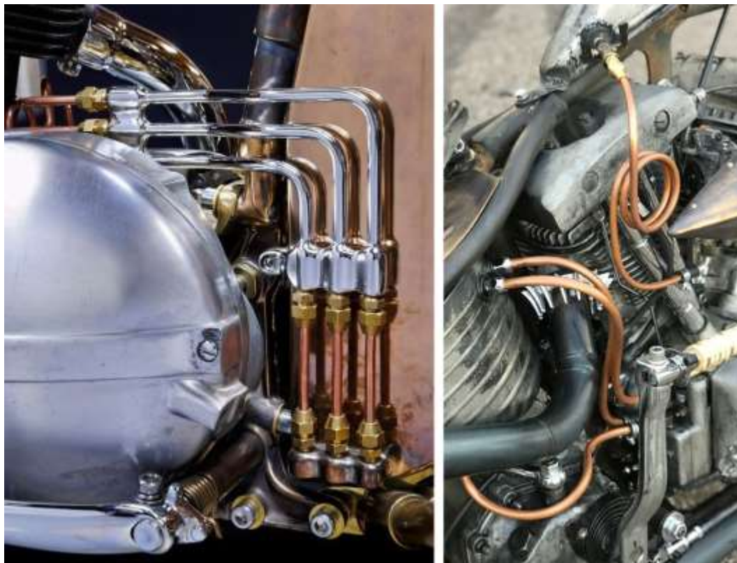
Rys. 13.14 Przykłady nieseryjnych elementów układów hydraulicznych w motocyklu Źródło: [8]
