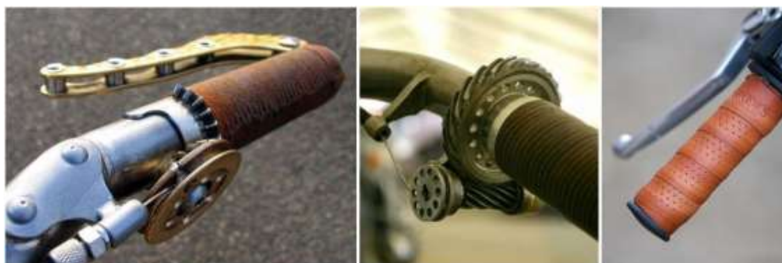
Rys. 13.12 Przykłady indywidualnego wykonania manetek i dźwigni ręcznych w motocyklu Źródło: [8]
