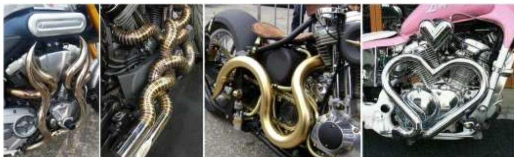
Rys. 13.7 Przykłady indywidualnego wykonania układów wylotowych spalin w motocyklach Źródło: [8]
