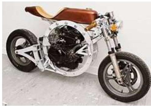
Rys. 13.9 Przykłady indywidualnego wykonania ramy nośnej motocykla
