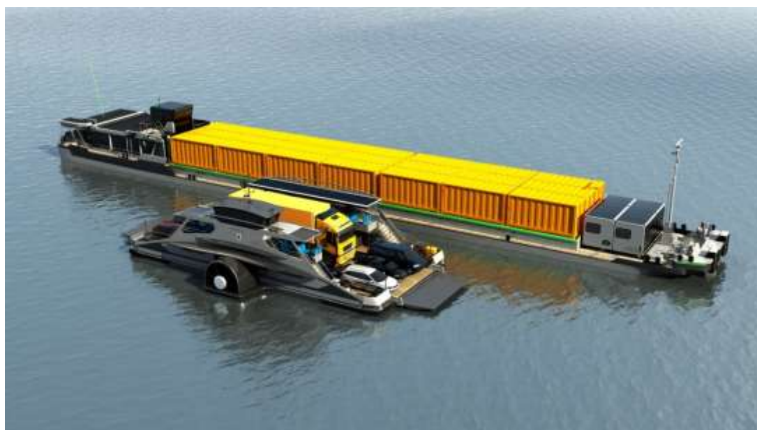
Rys. 12.1 Kontenerowiec zasilany LNG i prom bocznołowy, międzybrzegowy. Wizualizacja dwóch statków opracowywanych w ramach programu Mozart
