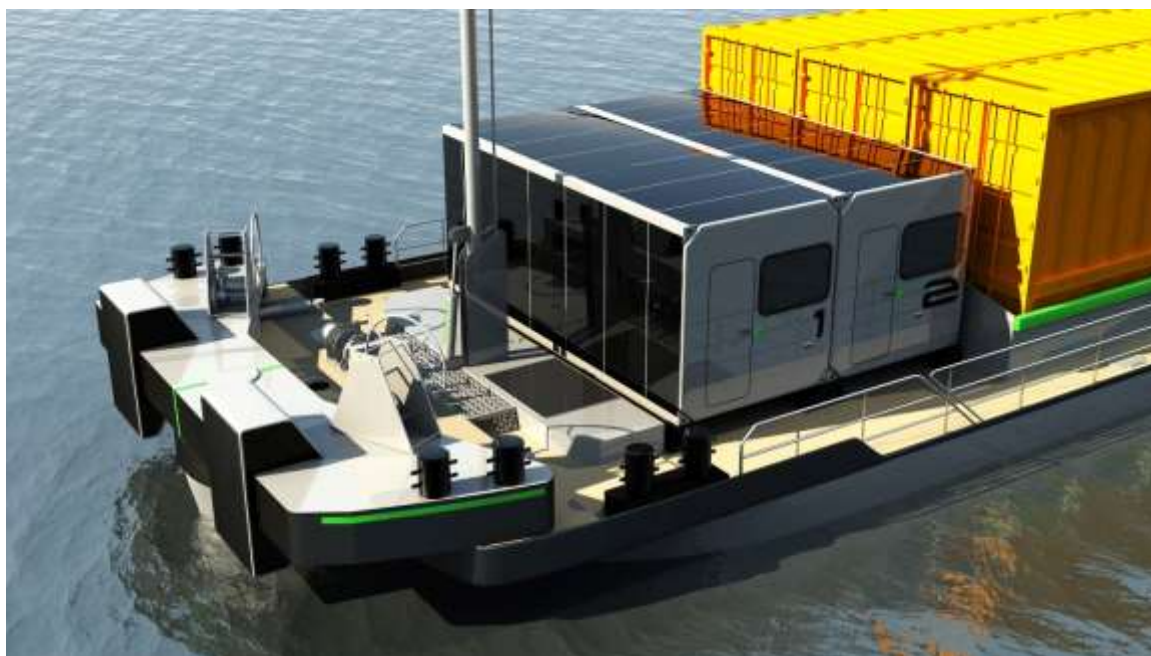
Rys. 12.8 Dziób kontenerowca z ruchomym elementem szczepiającym i kontenerami dla załogi badawczej
