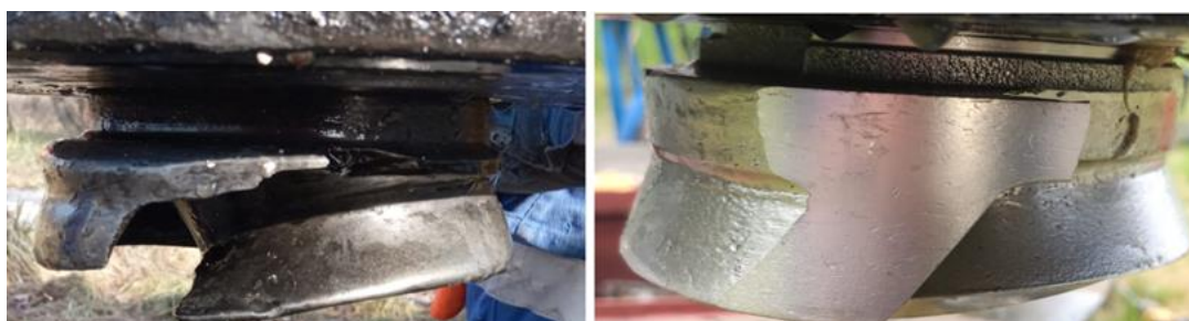
Rys. 4 Przykład nowego i zużytego wirnika hydraulicznego, który ma bezpośredni wpływ na zużycie energii elektrycznej przez pompę
