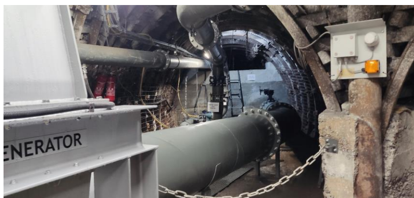
Rys. 5 Odprowadzenie wody do chodnika wodnego
