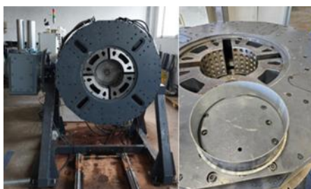
Rys. 3 Układ roboczy maszyny (po lewej) i odkształcona rura \varnothing 50 mm (po prawej)
