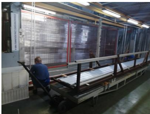
Rys. 1 Stanowisko pracy oraz postawa pracownika w przysiadzie podczas zawieszania profili na ramie w fazie przygotowawczej do anodowania
