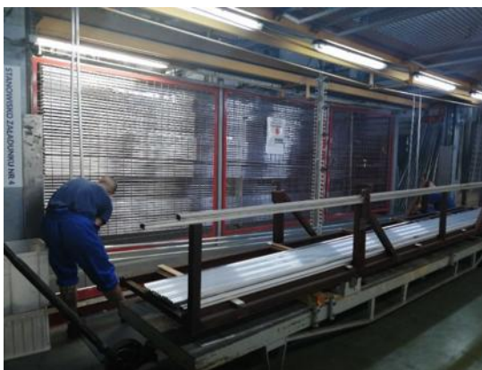
Rys. 2 Stanowisko pracy oraz postawa pracownika w pozycji stojącej pochylonej podczas zawieszania profili na ramie w fazie przygotowawczej do anodowania
