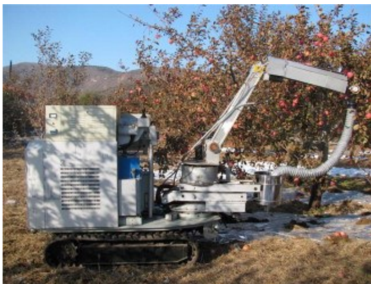
Rys. 3.11 Robot do zbierania jabłek
