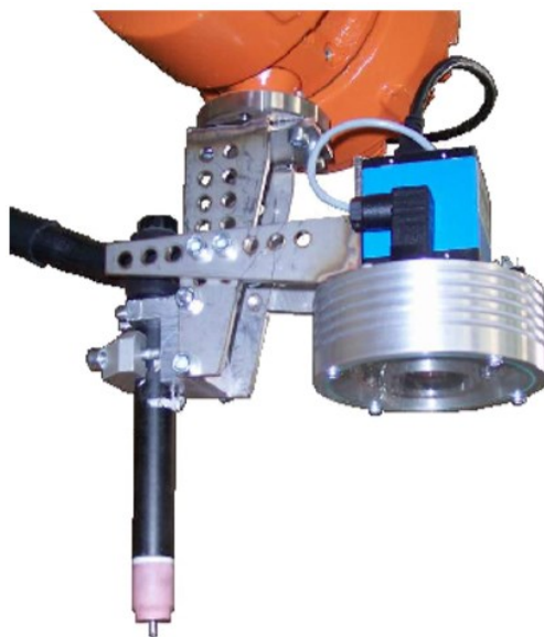
Rys. 3.13 System wizyjny wyznaczający położenie spawanych rurek wymiennika ciepła
