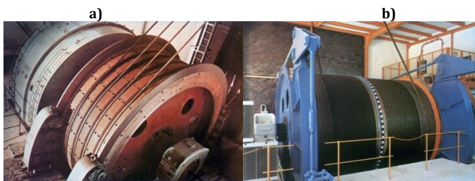
Rys. 1.2 Widok maszyn wyciągowych: a – z napędem ciernym, b – z napędem bębnowym
