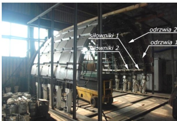
Rys. 18 Widok prototypu tymczasowej zmechanizowanej obudowy chodnikowej przed próbami stanowiskowymi
