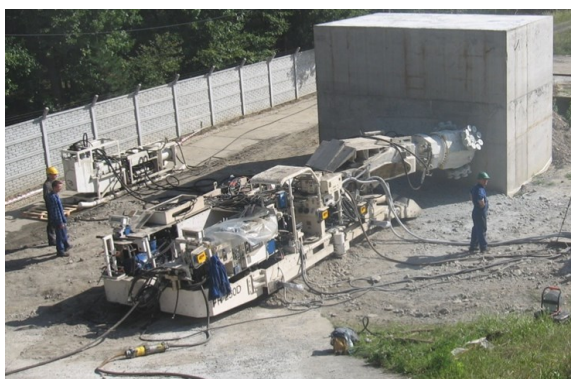
Rys. 16 Widok głowicy urabiającej z narzędziami dyskowymi zamontowanej na kombajnie FR 250 podczas prób poligonowych
