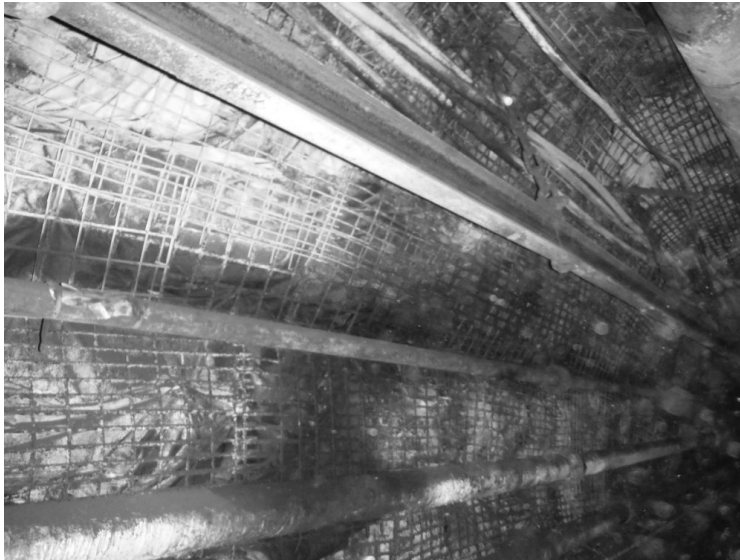
Rys. 2 Tradycyjny sposób wykonania profilaktyki p.poż. na obudowie
