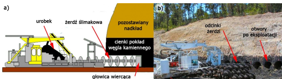
Rys. 3 Auger mining: a) schemat metody, b) eksploatacja Auger mining w hrabstwie Nicholas w USA
