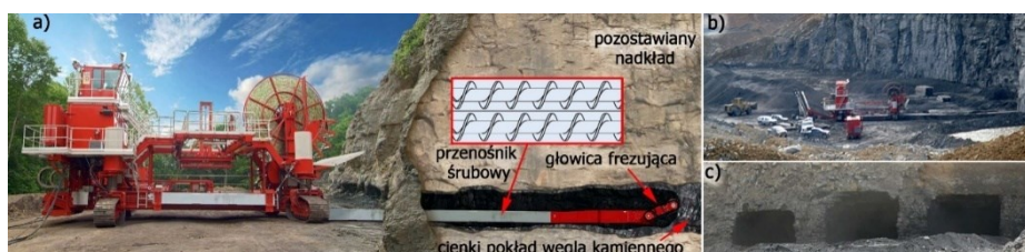
Rys. 8 Highwall mining: a) schemat metody, b) wyposażenie wyrobiska wraz z maszyną Terex SHM, c) wyrobiska po eksploatacji w hrabstwie Mingo w USA
