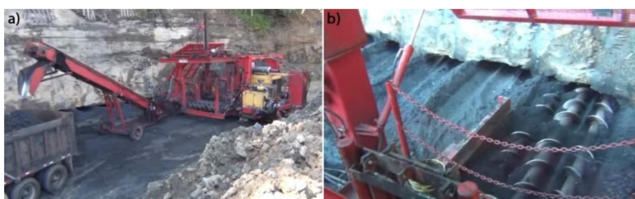
Rys. 5 Kombajn Auger miner , a) maszyna MCK-GS MUL-T firmy Salem Tool Inc., b) wierzenie trzema głowicami
