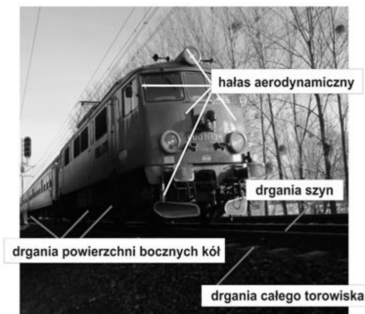
Rys. 14.1 Przyczyny powstawania dźwięków w trakcie ruchu pojazdu szynowego
