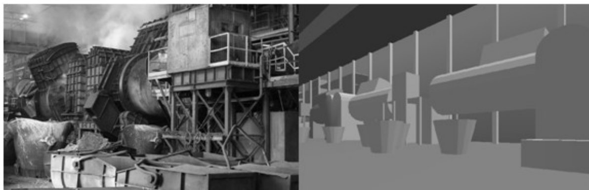
Rys. 19.2 Wygląd rzeczywistego obiektu przemysłowego i jego model geometryczny
